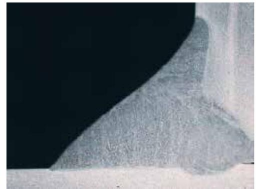
Die Schweißnaht zeigt eine Flachnaht mit einem etwas steilen Nahtübergang zum Gurtblech. Der typische fingerförmige Einbrand ist sichtbar.
