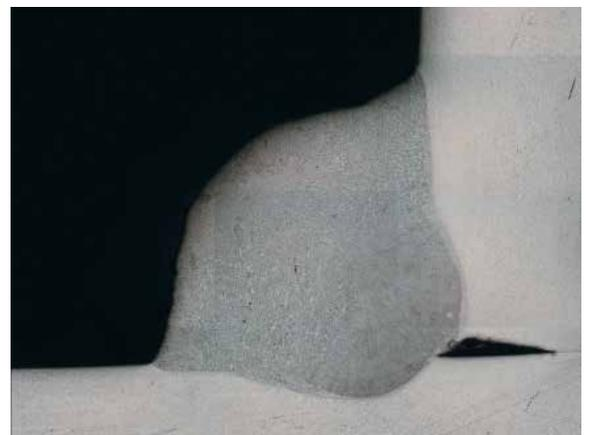
Der Ausschnitt zeigt eine stark überwölbte Naht, wie sie bei diesem Verfahren bei einer zu geringen Vorschubgeschwindigkeit charakteristisch ist. Folge hiervon sind eher schroffe Nahtübergänge, die nachteilig für eine Ermüdungsbelastung sind.
