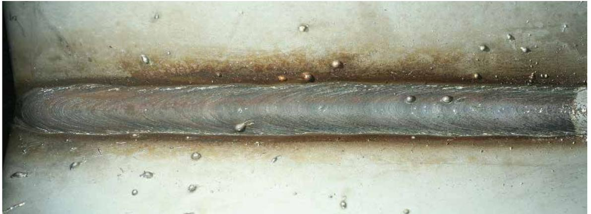
Zusatzwerkstoff: 1,0 mm, 19,9L Si Draht       $I$ : 140-170 A       $v$ : 25-30 cm/min
