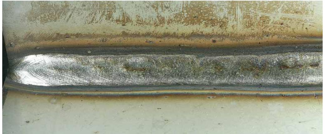
Zusatzwerkstoff: 1,2 mm, 19.9L Fülldraht     $I$ : 190-210 A     $v$ : 30-40 cm/min
