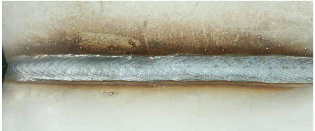
Zusatzwerkstoff: 1,0 mm, 19,9L Si Draht       $I$ : 140-170 A       $v$ : 25-30 cm/min
