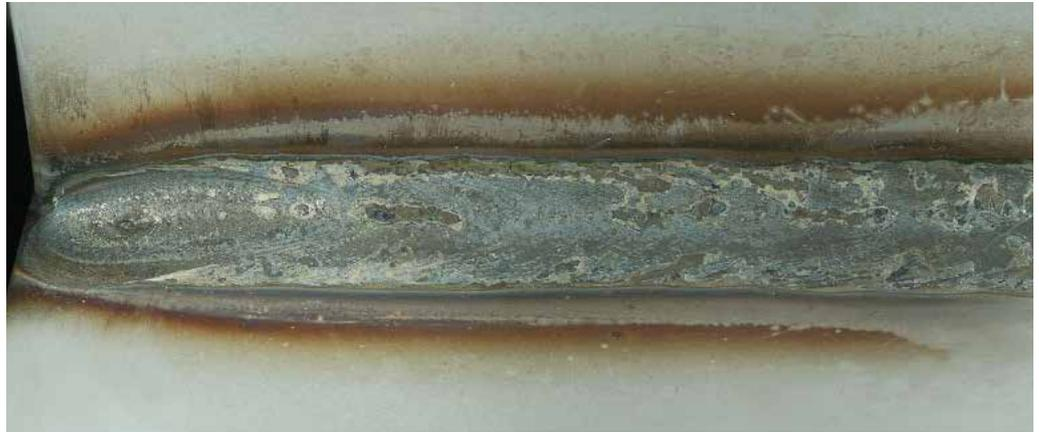
Zusatzwerkstoff: 1,0 mm, 19,9L Si Draht       $I$ : 180-200 A       $v$ : 25-30 cm/min
