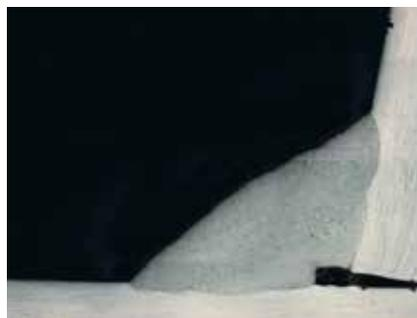
Der Ausschnitt zeigt eine leicht konvexe Schweißnaht mit ungenügendem Wurzeleinbrand.
