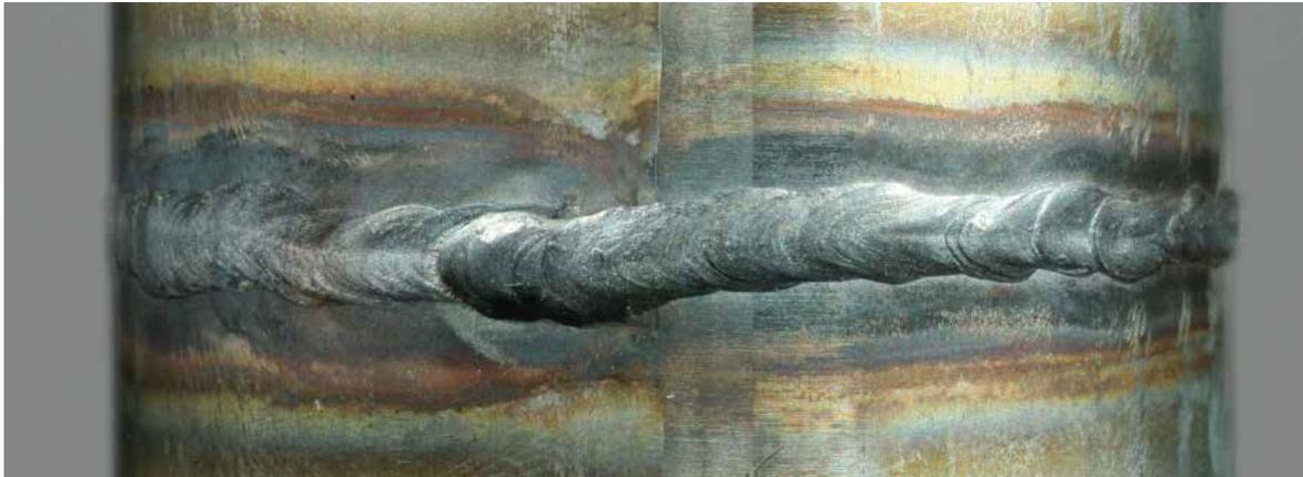
Zusatzwerkstoff: 1,6 mm, 19,9L Si Draht       $I$ : 40-50 A       $v$ : 4-6 cm/min
