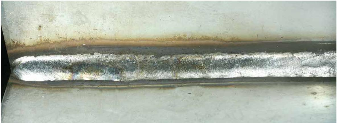
Zusatzwerkstoff: 1,2 mm, 19,9L Fülldraht     $I$ : 190-210 A     $v$ : 35-40 cm/min
