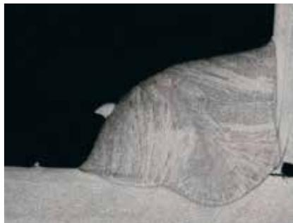
Der Ausschnitt zeigt eine konvexe Nahtüberhöhung. Eine höhere Spannung würde die Konvexität verringern. Auf der Oberfläche sind einige Spritzer. Dies ist für dieses Verfahren typisch.
