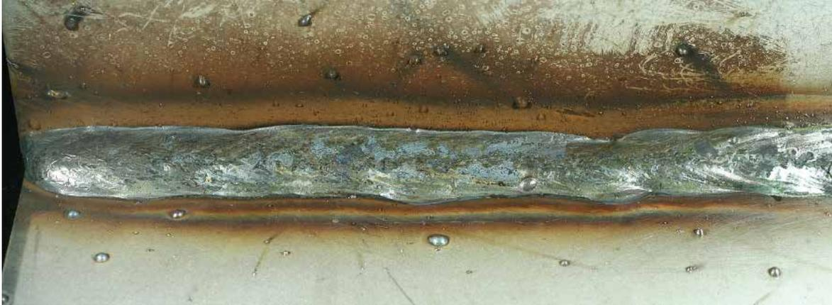
Zusatzwerkstoff: 1,0 mm, 19.9L Si Draht       $I$ : 120-140 A       $v$ : 12-16 cm/min
