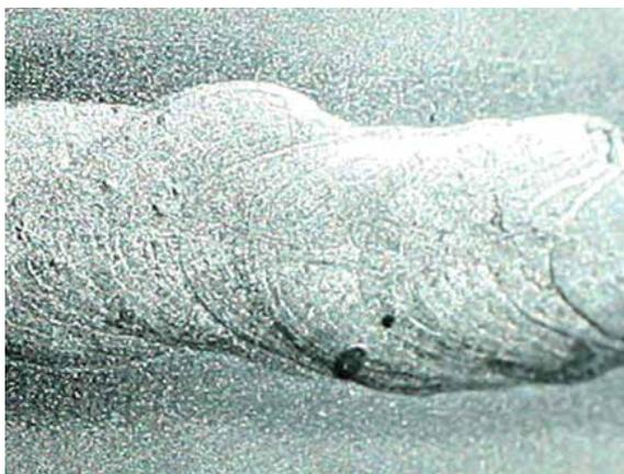
Nahaufnahme der Schweißnahtoberfläche; kleine Schlackepartikel sind sichtbar.
