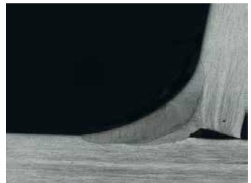
Der Ausschnitt zeigt eine sehr dünne konkave Schweißnaht mit einer ausgeprägten Ungleichschenkligkeit, Wurzelfehler.
