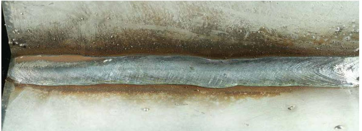
Zusatzwerkstoff: 1,0 mm, 19,9L Si Draht       $I$ : 160-180 A       $v$ : 25-30 cm/min
