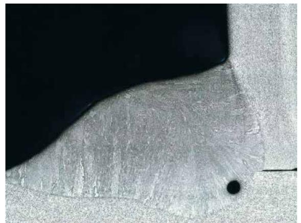
Der Ausschnitt zeigt eine asymmetrische und konvexe Nahtüberhöhung. Im Wurzelbereich ist eine Pore sichtbar.
