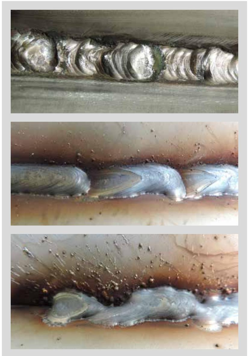
**Bild 2: Fehlerhafte Schweißnähte**
