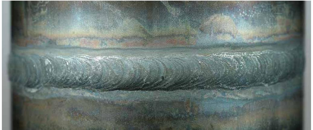
Zusatzwerkstoff: 1,6 mm, 19.9L Si Draht       $I$ : 45-55 A       $v$ : 4-6 cm/min
