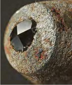
Pyramidenförmige Spitze eines Vickers-Härtetesters
