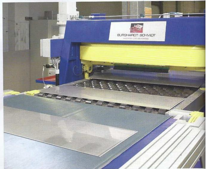
Präzise Schnittführung ist ebenso gewährleistet wie ein kratzerfreies und kantengenaueres Abstapeln. Auf Wunsch können die Platinen mittels Tintenstrahldrucker beliebig gekennzeichnet werden. Zusätzlich lassen sich die Oberflächen der Flacherzeugnisse durch das Ein-
