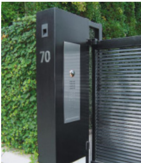
Klingel, Gegensprechanlage und Beschriftung sind auf reduzierte und hochwertige Weise in die Eingangssituation eingebettet. Edelstahl eignet sich beim Einsatz im Außenbereich besonders aufgrund seiner Korrosionsbeständigkeit und Langlebigkeit.
