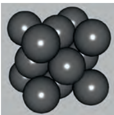
Austenitisches (kubisch-flächenzentriertes) Gefüge
