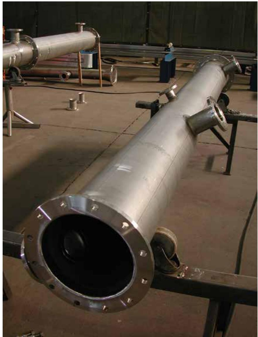
**Bild 3:** Fertigung von Sprühdüsen aus dem hochlegierten nichtrostenden korrosionsbeständigen Stahl X1NiCrMoCu32-28-7 (1.4562) für den Rauchgaswäscher eines Kraftwerks im slowenischen Sostanj (Foto: Heinz Gothe GmbH & Co. KG, Mönchengladbach)
