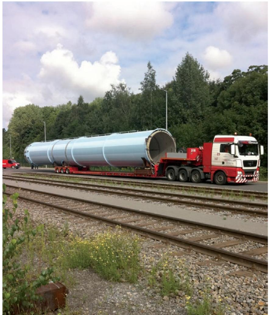
Bild 1: Transport eines doppelwandigen Schornsteines (Foto: Caligo Schornsteinbau GmbH, Hopsten)
