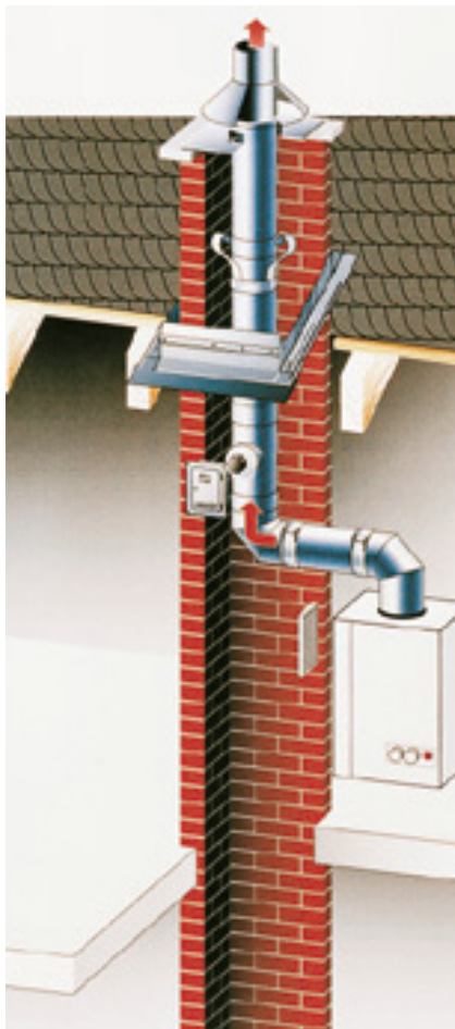
Bild 11: Ausführung einer überdruckdichten Abgasleitung für die Brennwerttechnik
