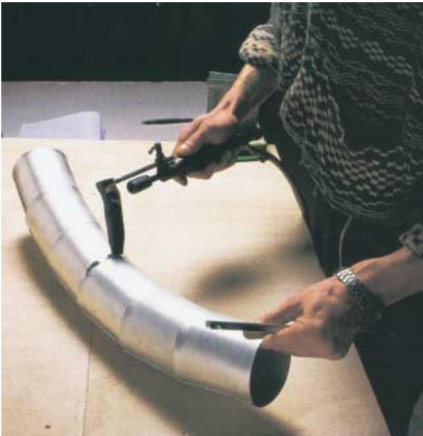
Der Lötspalt sollte zur Erzielung hoher Nahtfestigkeit 0,5 mm nicht überschreiten. Größere Lötspalte sind durch geeignete Maßnahmen, z.B. Nachspannen, Heftnieten, zu verringern. Beim Löten von Bauteilen mit Materialdicken größer als 0,8 mm wird ein Vorverzinne der Lötnaht-Flächen empfohlen, um auch hier Lötspalte von max. 0,5 mm sicherzustellen. Größere Lötspalte verschlechtern die Lötnahtfestigkeit deutlich.
