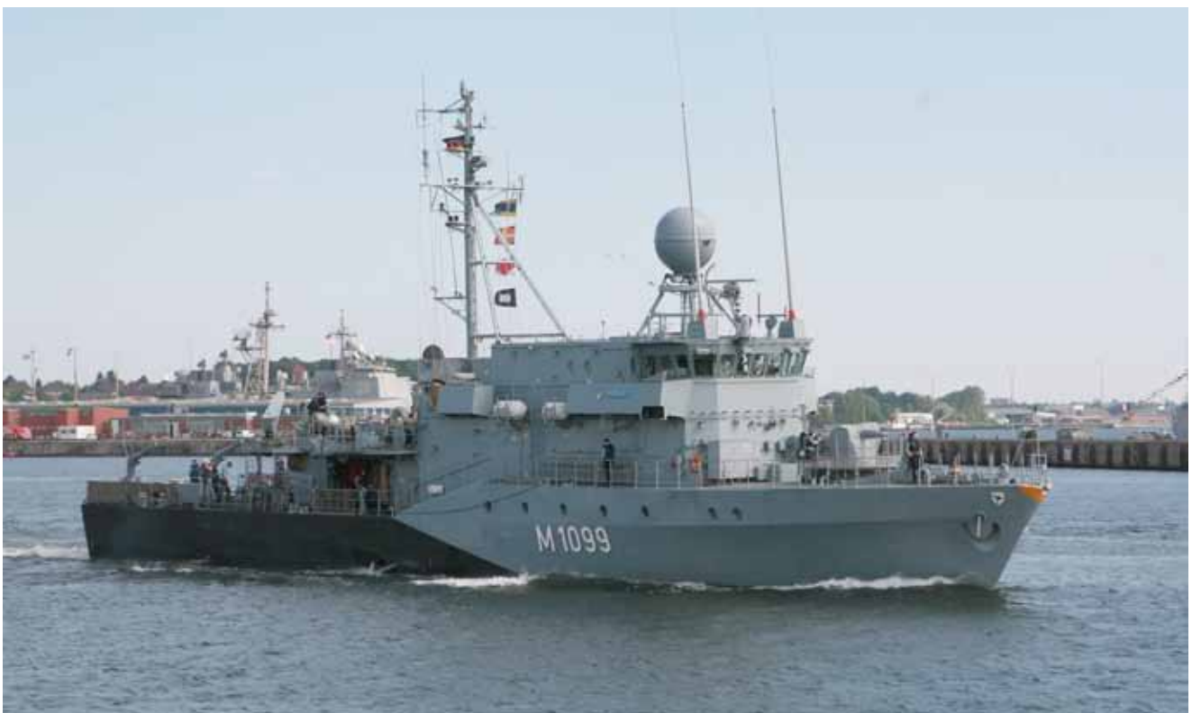
Bild 11: Anwendung des nichtmagnetisierbaren austenitischen korrosionsbeständigen Stahls 1.3964 beim Bau des Minensuchers „Herten“ (Foto: Deutsche Marine)
