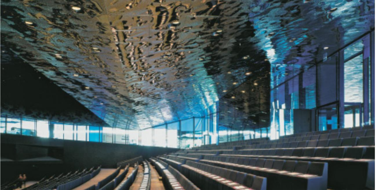
*Im Auditorium setzt sich die Deckenverkleidung des Außenraums an der Unterseite des Balkons fort. An der Decke sind die Edelstahlbleche zusätzlich elektrolytisch blau gefärbt.*
