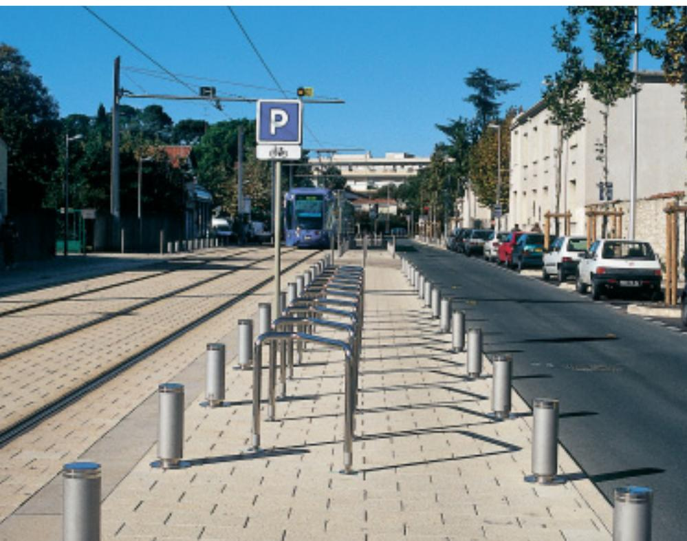
Entlang der Trambahnlinie 1 in Montpellier markieren Edelstahlpoller die Abgrenzungen der verschiedenen Verkehrsbereiche für Autos, Fußgänger und Trambahn. Sie zeichnen sich durch eine kombinierte Oberfläche, matt gebürstet und hochglanzpoliert, aus und sind mittels einer Bodenplatte befestigt. Die Anlehnbügel für Fahrräder sind ebenfalls aus poliertem Edelstahl gefertigt.
