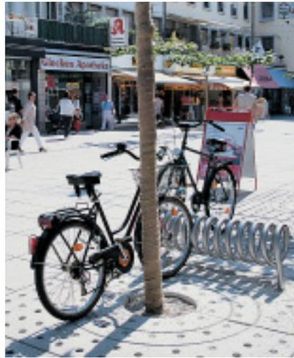
Der spiralförmige Fahrradständer aus gebogenem Edelstahlrohr lässt sich von zwei Seiten nutzen.
