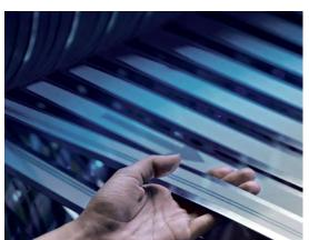
Durch partielle Folienbeschichtung von Spaltbändern schützt man gezielt die Sichtflächen des späteren Profils.
