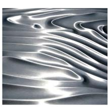
Durch hydromechanische Umformverfahren lassen sich Bleche und Gewebe in jede erdenkliche Form bringen.
