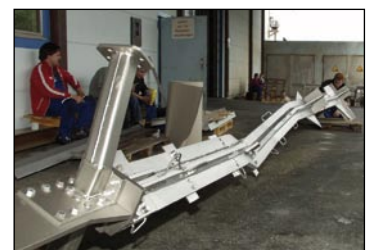
▲ Geschweißtes Bauteil der Innenkonstruktion. Bild 31c90624.tif
