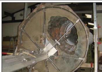
▲ Herausforderung für die Schweißer: Ringe zur Befestigung der Außenhülle. Bild 31c90625.tif
