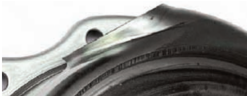
Die Spiralform wird durch Innenhochdruckumformung in das Pumpengehäuse eingebracht. Die Auslassöffnung ist mechanisch sorgfältig nachbearbeitet, so dass ein höchstmöglicher Wirkungsgrad erreicht wird.
