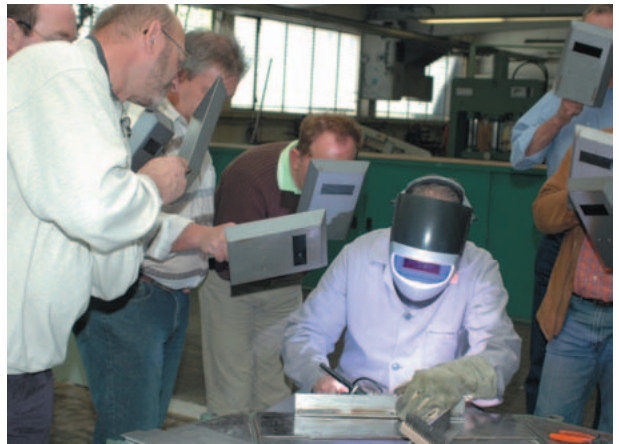
Fasziniert beobachten die Teilnehmer des Schweißtages im BTZ Augsburg, wie WIG-Kaltdrahtschweißen mit doppelter Geschwindigkeit funktionieren kann
