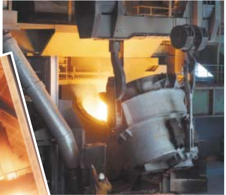
Chargieren (Befüllen) des Konverters
