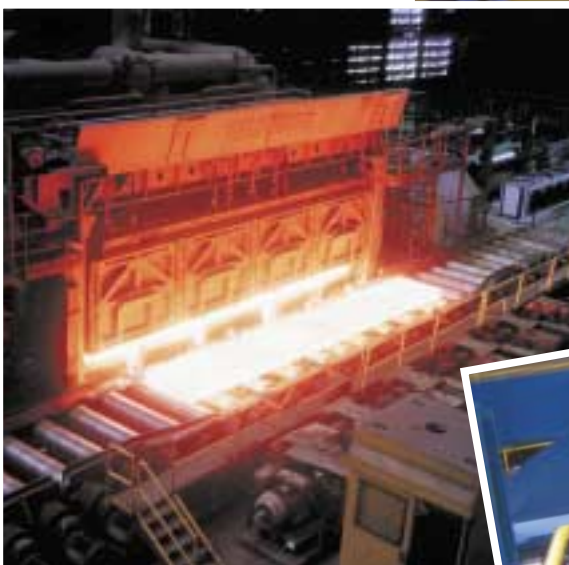
Eine auf Walztemperatur aufgeheizte Bramme verlässt den Ofen und wird auf dem Rollgang zu den Walzgerüsten gefahren
