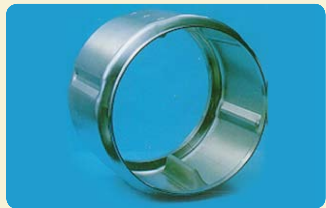
Tambour de sèche-linge-tôle en 409 soudé, formé par expansion.
