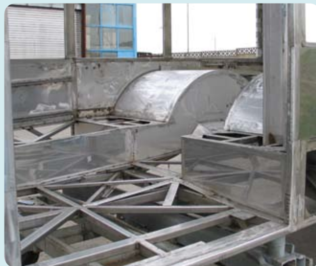
Ossature de bus soudée en nuance 1.4003.
