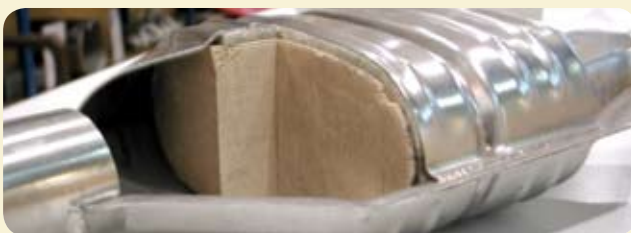
Carter de catalyseur embouti en nuance 441.
