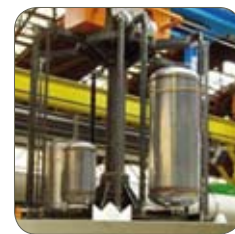
Réservoir soudé en nuance 444, Europe.
