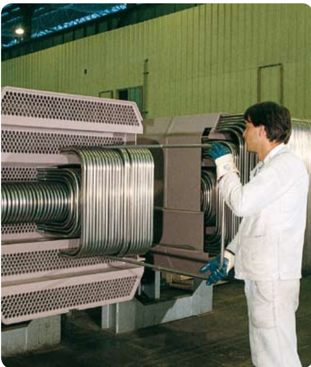
Tubes de condenseur-réchauffeur en nuance 439, Europe.
