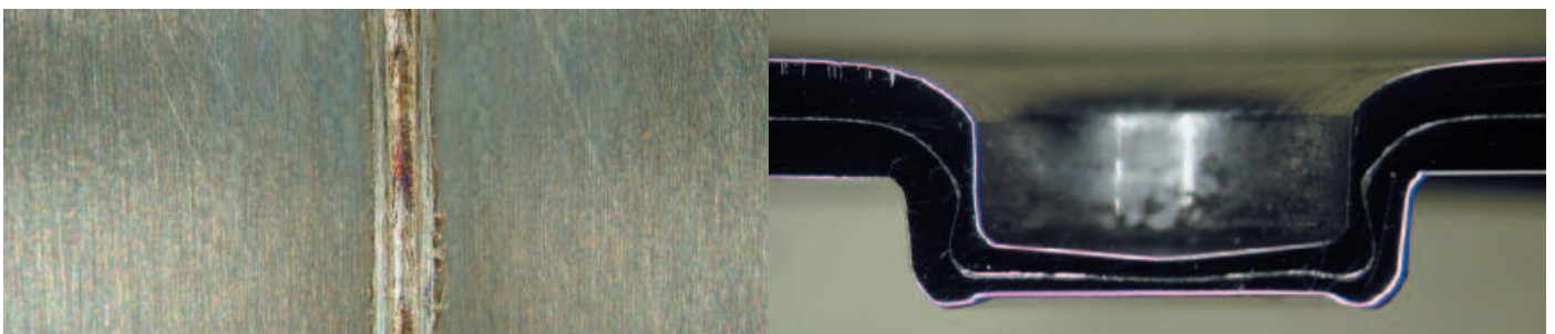
Bild 8 | Fügen mittels Laserschweißen und Clinchen
