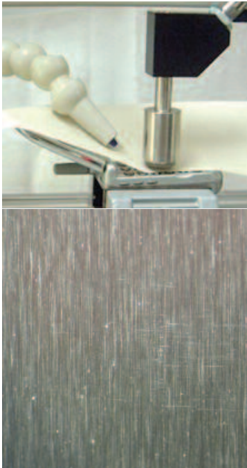
Bild 6 | Abrasionsverhalten nach 100.000 Zyklen
