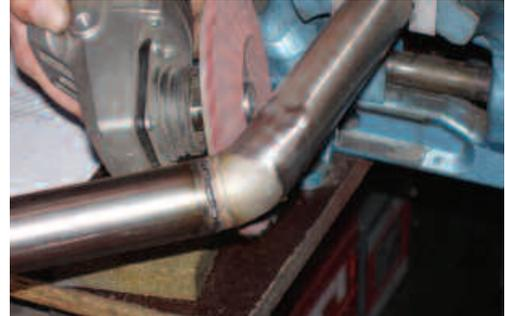
*Anschluss mit eingeschweißtem Bogen*
