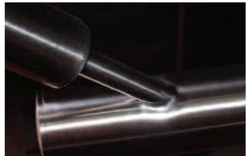
Bei Handlauf- und Geländeranlagen werden die Rohre häufig nicht direkt, sondern durch Stäbe miteinander verbunden. Das Schweißen wird hierdurch vereinfacht, gleichzeitig verbessert sich die Zugänglichkeit für die Nachbearbeitung gegenüber dem direkten Verschweißen der Rohre miteinander.
