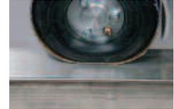
Beim manuellen Schleifen müssen Temperatur und Druck begrenzt werden. Werkzeugführung, Anpressdruck und Umdrehungsgeschwindigkeit beeinflussen allesamt das Ergebnis.
