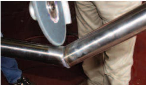
*Bearbeitung der Innenseite mit einem Winkelschleifer*
