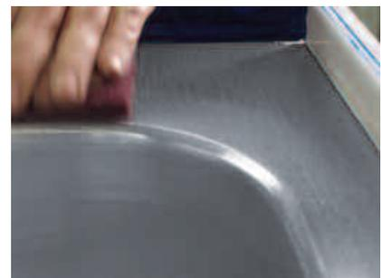
Nach dem anfänglichen Grobschliff wird die Naht mit Handschleifern und zunehmend feineren Fächerscheiben bearbeitet. Die abschließende Angleichung des Schliffbildes von Spülbecken und -tafeln erfolgt von Hand, z.B. durch sorgfältige Behandlung von Scotch-Brite™-Kissen oder ähnlichem.
