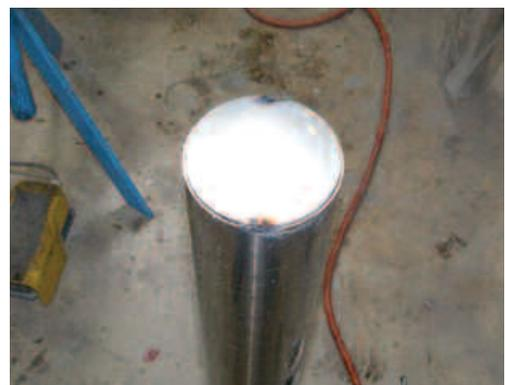
Die durchgehende Schweißnaht verleiht der Konstruktion Festigkeit und Dichtigkeit.
