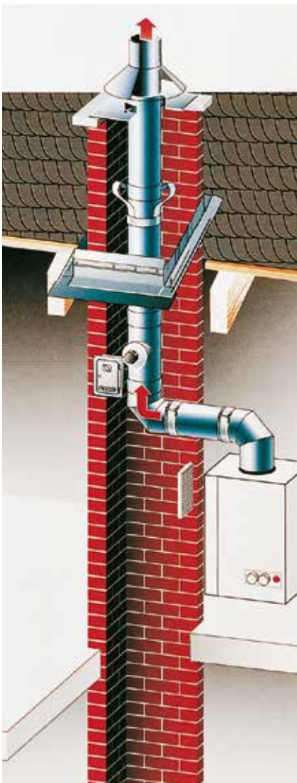
Bild 11: Ausführung einer überdruckdichten Abgasleitung für die Brennwertechnik
