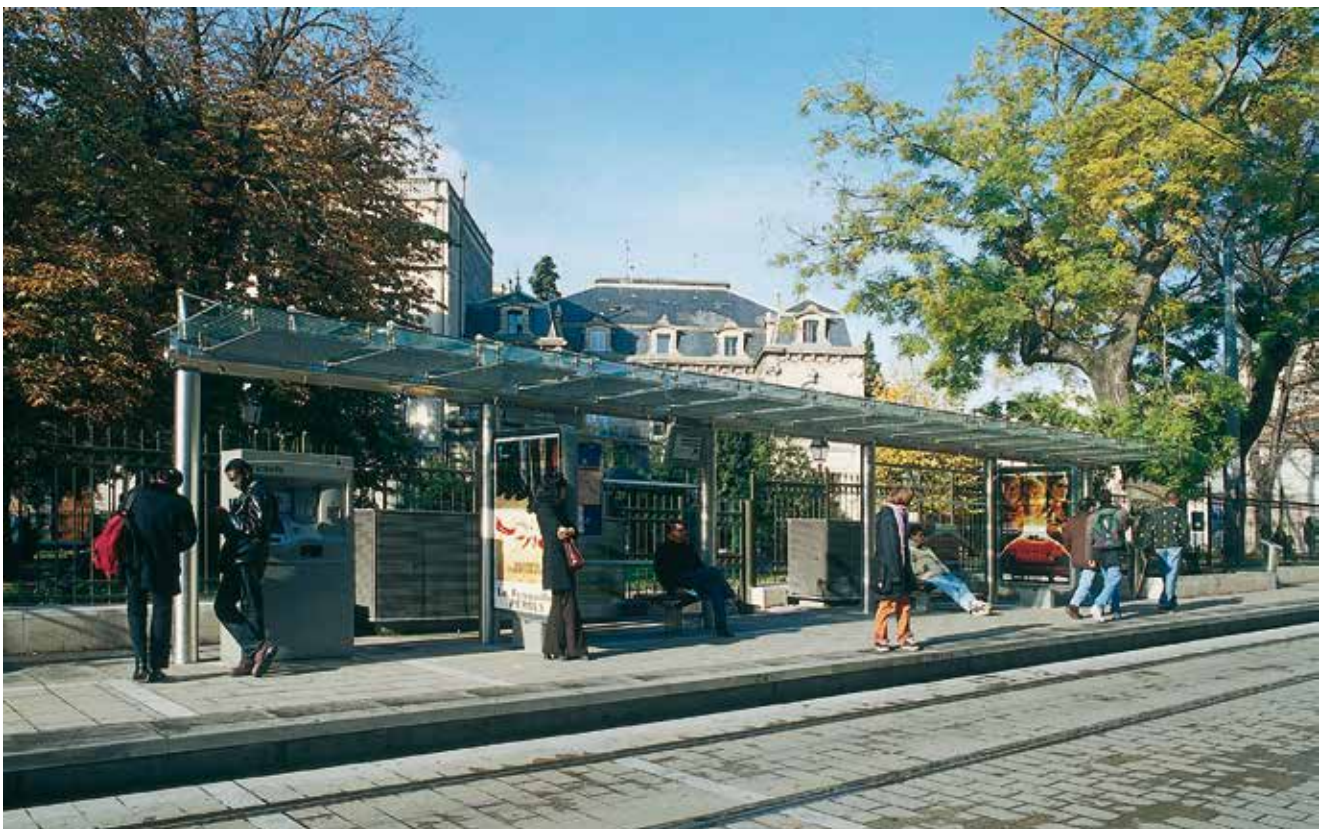
Bild 7: Der nichtrostende Stahl 1.4404 mit polierter Oberfläche widersteht den Abgasen des Verkehrs ebenso wie der Seeluft des nahen Mittelmeeres (Foto: Claude O`Sughrue, Montpellier (F))
