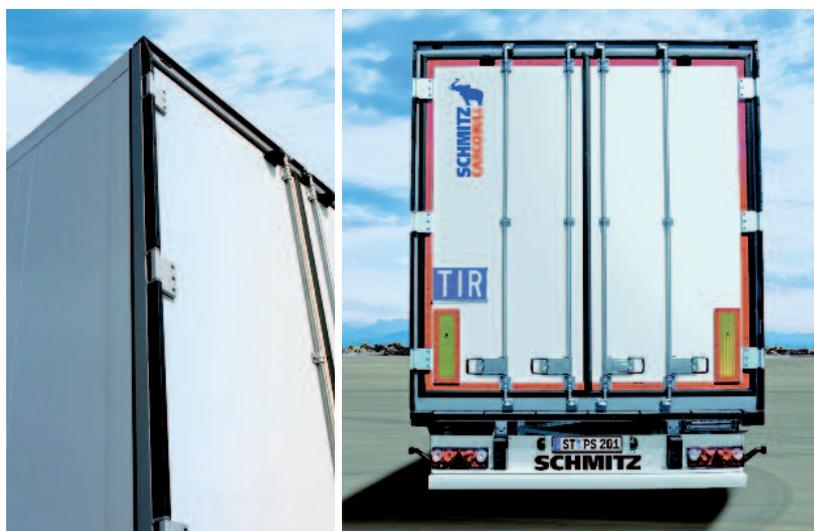
Abb. 22: Geklebter Rückwandrahmen eines Aufliegers für den Tiefkühlfrachtverkehr
