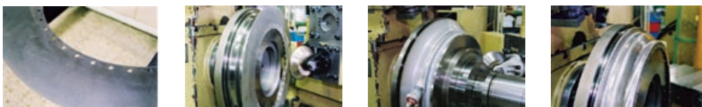
Repoussage au tour de la jante extérieure en acier inoxydable. La résistance mécanique de l'acier inoxydable va se renforcer lors du formage, procurant ainsi un potentiel intéressant pour absorber les chocs.
