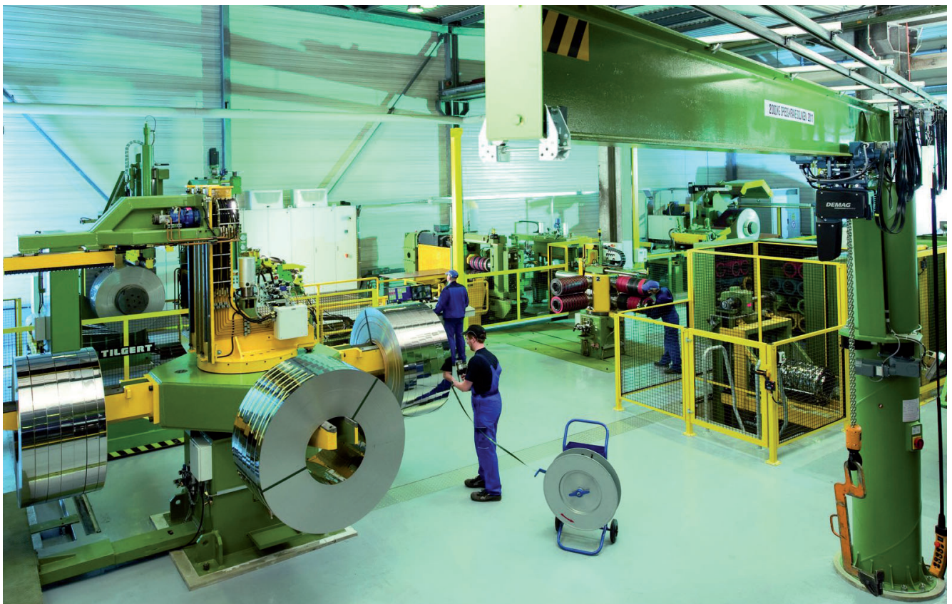
Gesamtansicht der neuen Längsteilanlage, mit der Aufwickelgruppe im Vordergrund.
