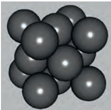
Atomes dans une structure austénitique cubique face centrée
