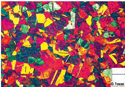
Vue micrographique de la structure cristalline austénitique d'aciers inoxydables au chrome et au nickel
