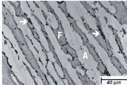
**Abbildung 4:** Gefüge einer Probe des Stahls EN 1.4462 (2205), 40 min lang gehalten bei 850 °C (1560 °F) und mit erkennbarer Sigmaphasenausscheidung (Pfeile) an den Austenit/Ferrit-Korngrenzen. Die Ferritphase (F) erscheint im Gefügebild [3] dunkler als die Austenitphase.
