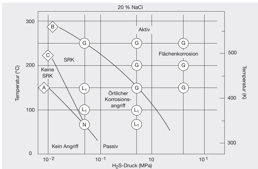
**Abbildung 10: Korrosion des nichtrostenden Duplexstahls EN 1.4462 (2205) in 20%iger Natriumchlorid-Schwefelwasserstoff-Umgebung, basierend auf elektrochemischer Vorhersage und experimentellen Ergebnissen**
