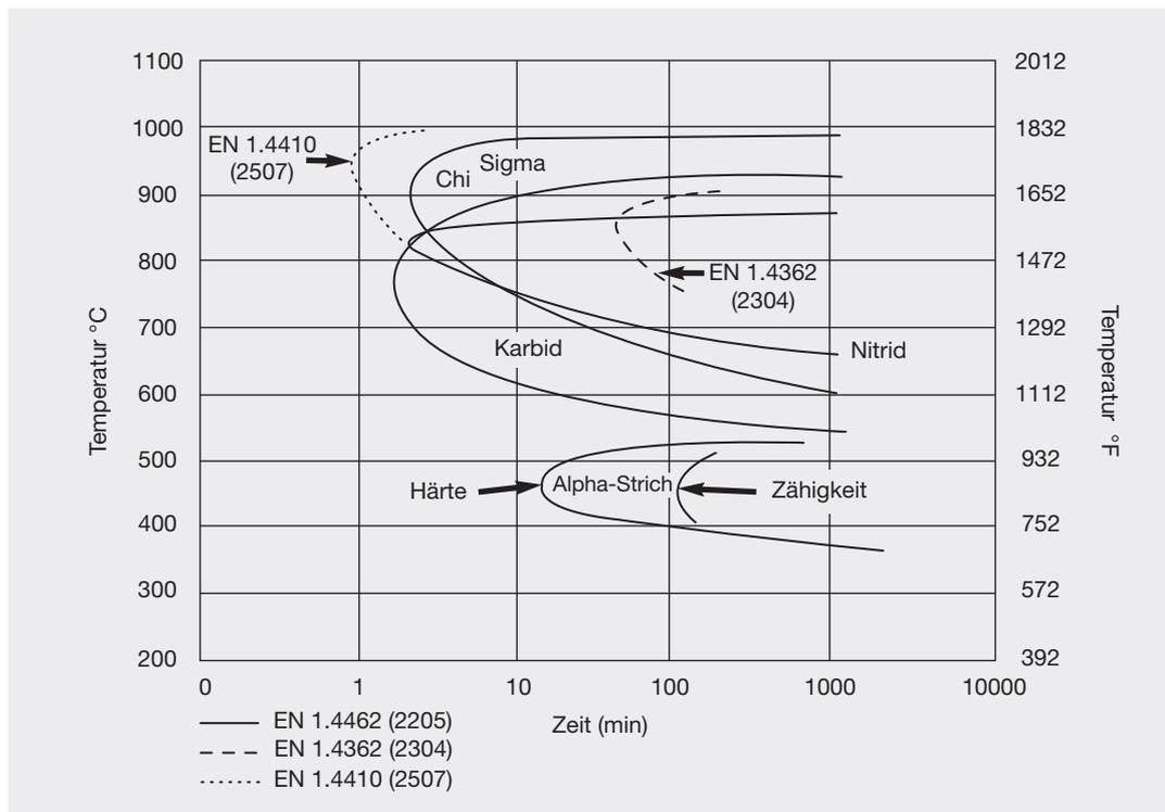
**Abbildung 5:** Isothermes Zeit-Temperatur-Ausscheidungsdiagramm für den nichtrostenden Duplexstahl EN 1.4462 (2205), gegläht bei 1050 °C (1920 °F). Zum Vergleich ist auch das Verhalten der Duplexsorten EN 1.4410 (2507) und EN 1.4362 (2304) gezeigt.
