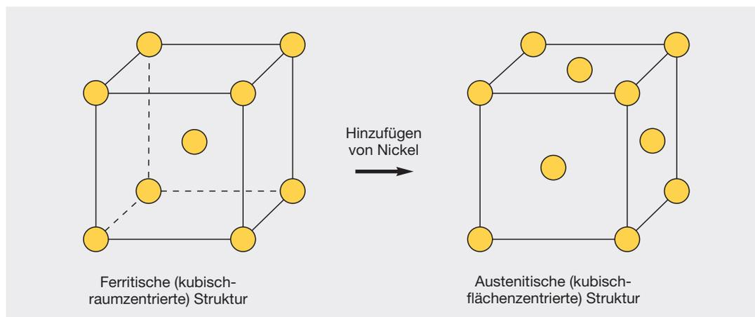
**Abbildung 1:** Durch Hinzufügen von Nickel verändert sich die kristallographische Struktur von kubisch-raumzentriert (wenig oder kein Nickel) zu kubisch-flächenzentriert (mindestens 6 % Nickel; AISI-300er-Serie). Nichtrostende Duplexstähle weisen aufgrund ihres mittleren Nickelgehaltes ein Gefüge auf, in dem ein Teil der Körner ferritisch und der andere Teil austenitisch ist. Im Idealfall liegen beide zu annähernd gleichen Teilen vor (Abbildung 2).
