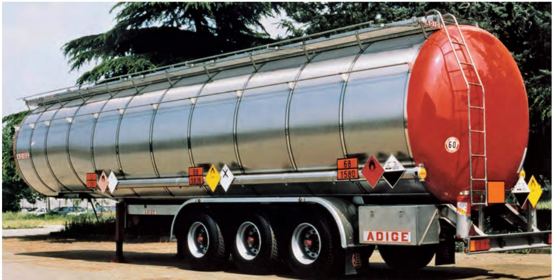
Asphalttransporter aus nichtrostendem Duplexstahl (Quelle: Outokumpu)
