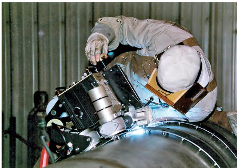
**Mechanisertes Schweißen von Großrohren aus nichtrostendem Duplexstahl bei einer Pipeline an der Nordküste Alaskas (Quelle: Arco Exploration and Production Technology)**
