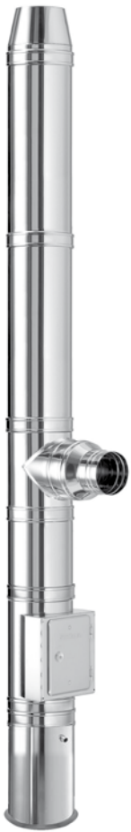
Bild 9: Bei doppelwandigen Abgasanlagen bestehen häufig das abgasberührende Innenrohr und das lediglich atmosphärisch beanspruchte Außenrohr aus unterschiedlichen Sorten nichtrostenden Stahls. Foto: Schiedel, Wien (A)
