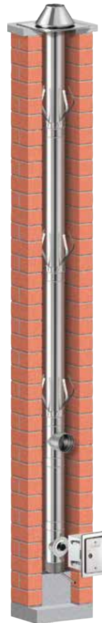
Bild 11: Starre Kamineinzugsrohre vermindern den Querschnitt bestehender Schornsteine. Sie verbessern dadurch den Kaminzug und beugen Kondensation vor. Foto: Schiedel, Wien (A)
