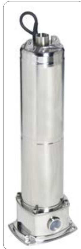
Tauchpumpe; Motor-/ Pumpenwelle, Impeller und Wellenschutzhüllen aus nichtrostendem Stahl EN 1.4028 (AISI 420)
