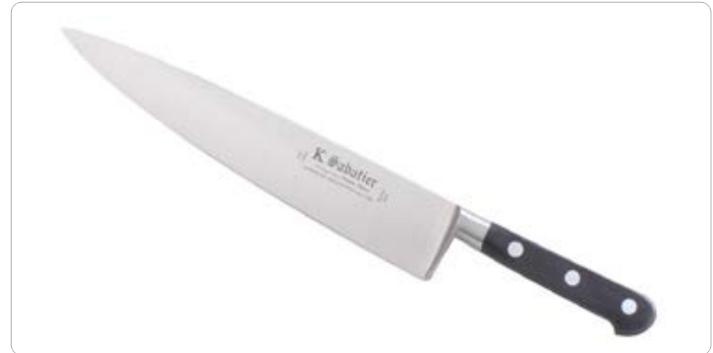
Gewerbliches Tranchiermesser aus nichtrostendem Stahl mit 0,5 % C und 13 % Cr, geschmiedet und durch Wärmebehandlung auf eine Härte von 55 HRC gebracht (Foto: Sabatier-K)
