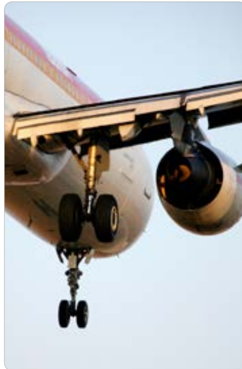
Fahrwerksteile aus den Werkstoffen EN 1.4548 (17-4PH), umgeschmolzen, und EN 1.4545 (AMS 5659, ASTM 564) (Foto: Iconos)
