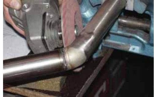
Anschluss mit eingeschweißtem Bogen
