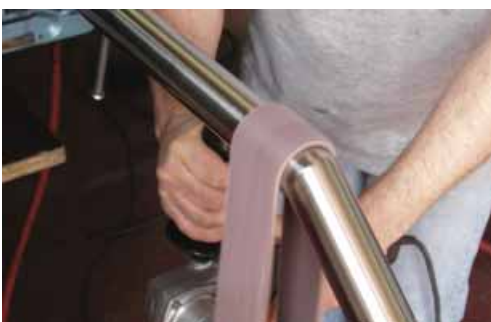
Abschließende Angleichung mittels eines handgeführten Bandschleifers; die Kante bleibt erhalten, ohne als Schweißnaht erkennbar zu sein.
