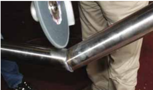
Bearbeitung der Innenseite mit einem Winkelschleifer
