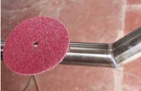
Gehrungsschnitt mit einfacher Schweißnaht
