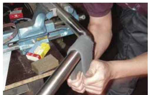
Herstellung einer optisch nahtlosen Verbindung
