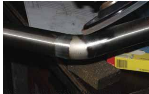
Bearbeitung der Außenseite mit einer Fächerscheibe
