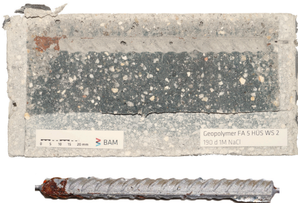
Abb. 61: Foto von gespalteener FA D WS 2 Probe nach Depassivierung von Bewehrungsstahl mit Bewehrungsstahlzustand.
