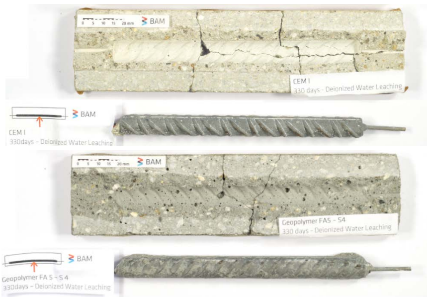
Abb. 23: Repräsentative Proben nach 330 Tagen Auslaugung in voll-entionisiertem Wasser. CEM-Referenzmörtel (oben) und Geopolymermörtel (unten).
