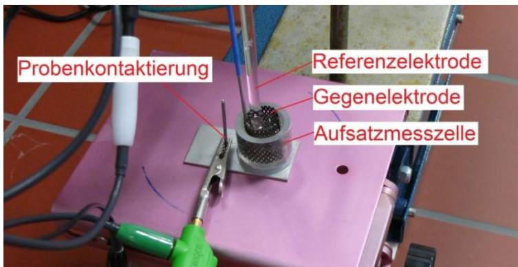
Abb. 19: Proben Setup für die Spaltkorrosionsversuche
