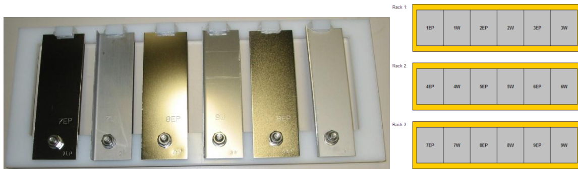
Abb. 6: Probenträger (Racks) für die Auslagerung in der Lebensmittelindustrie
