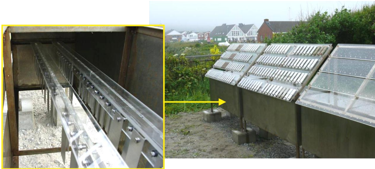
Abb. 4: Übersicht Auslagerungsstände auf Helgoland (Meeresatmosphäre), überdachte Auslagerung in Kammer (links), freibewitterte Auslagerung (rechts)
