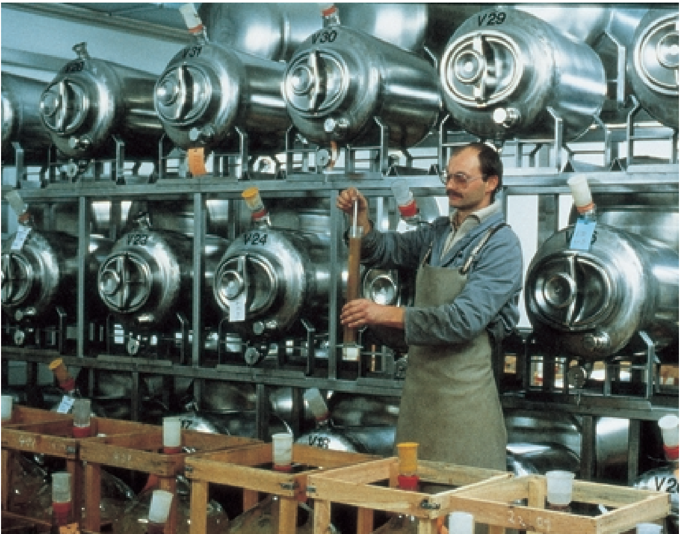
Bild 4: Für die Lagerung von Süßreserve werden – in Abhängigkeit vom Schwefelgehalt – meist molybdänhaltige nichtrostende Stähle empfohlen.
