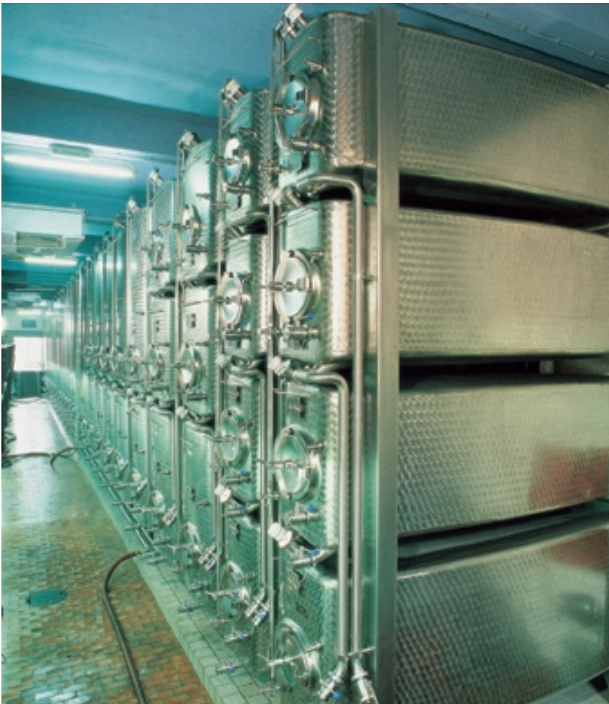
Bild 1: Raumsparende Kubiktanks aus Edeltahl Rostfrei stehen bis zu einem Fassungsvermögen von 75.000 Litern zur Verfügung.
