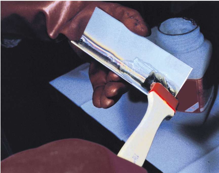
Bild 7: Um einzelne Schweißnähte von Anlauffarben und Schweißrückständen zu befreien, werden beim Nahtbeizen streichfähige Beizpasten mit einem säurefesten Pinsel aufgetragen
