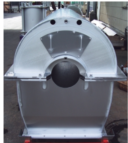
Bild 3: Der Beizprozess ist ein besonders geeignetes Verfahren, Anlauffarben im Bereich geschweißter Verbindungen sicher zu entfernen und die ursprüngliche Korrosionsbeständigkeit wieder herzustellen
