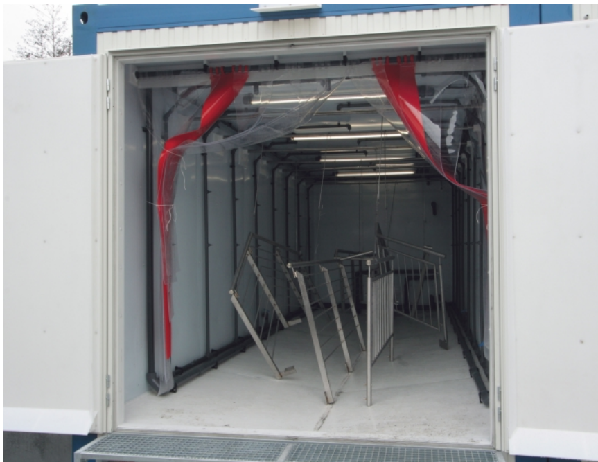
Bild 6: Für Edelstahlteile, die sowohl in einem Beizbad getaucht werden können als auch nur im Sprühbeizverfahren zugänglich sind, bietet sich ebenso das Rotationsbeizverfahren in einem Beizcontainer an
