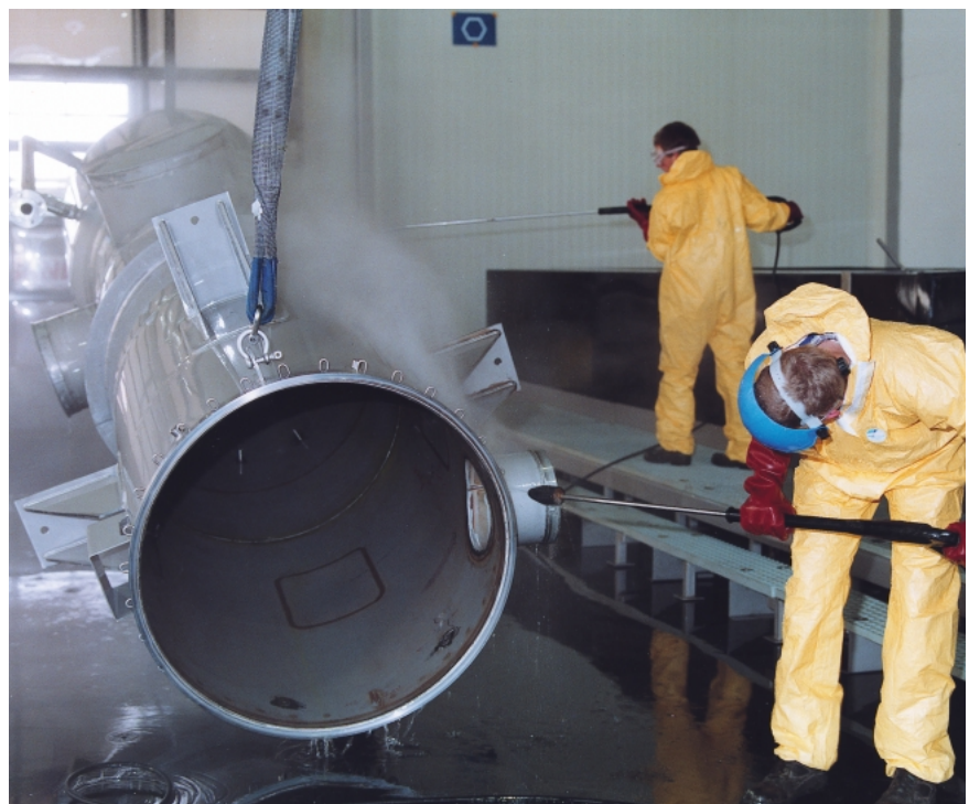
Bild 8: Zum Abschluß jeder Beizbehandlung müssen die Werkstücke von allen Beizmitteln und Beizrückständen (Beizbast) freigespült werden
