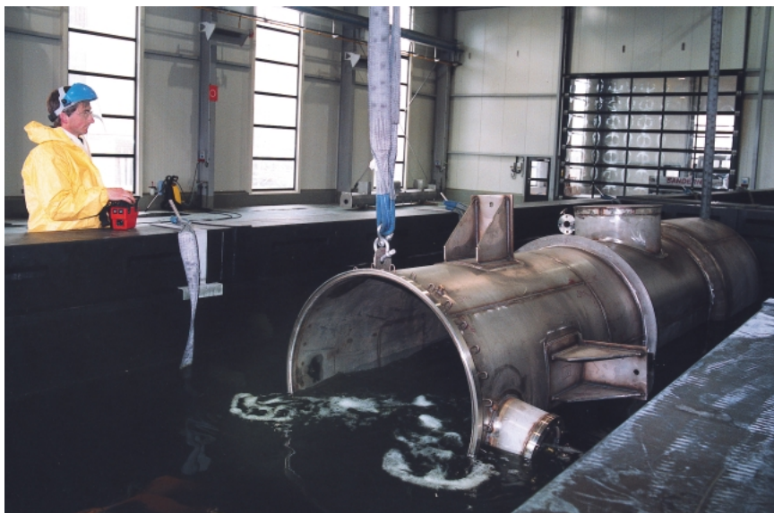
Bild 5: Sofern die Abmessungen der Konstruktion dies zulassen, kann das gesamte Bauteil im Tauchbeizverfahren behandelt werden
